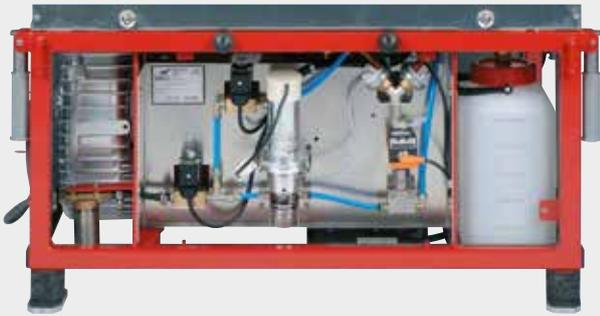
**Transporte de la preparación química** en los equipos Fontan Mobilstar E y ER a través de una bomba de engranajes en acero inoxidable resistente a productos químicos, con regulación electrónica de las revoluciones, de la cual depende el caudal.
