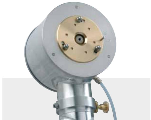
**Cabezal de nebulización** del Fontan Mobilstar con disco de ajuste para ULV y LV. En la posición „LV” se reduce la cantidad de aire en la salida de la niebla, para la producción de gotas más grandes.
